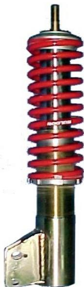
Amortiguador delantero con 3 vías de regulación y soporte rígido para acumulador
