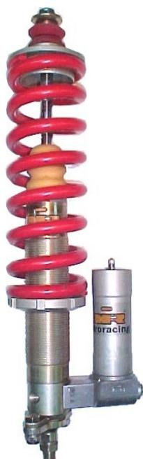
Amortiguador delantero con 3 vías de regulación y soporte rígido para acumulador
