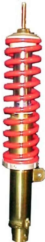
Amortiguador delantero con 3 vías de regulación
