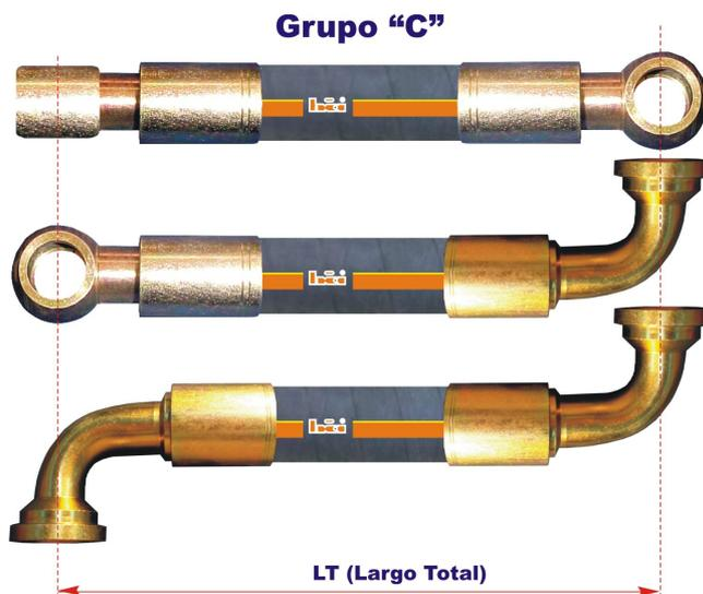
**PARA GRUPO "C":** Se toma la distancia LT para ambos extremos con terminales a 45° o 90° que tenga cualquier forma. Se toman los centros de las figuras y los ángulos de desplazamiento de un terminal con el otro se tomará rebatiendo la manguera y aplicando el sentido horario.
